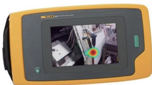
超音波測定用のセンサーを使用してリークの際に出る可聴域外の音をキャッチし可視化します。この原理によって、離れた位置のリークや目視で確認が難しいリークを特定します。音をセンサーで検知するため周囲の環境やリークの種類、ガスの性質によって変動がありますが、10m程度離れたリークも見つけることができます。
