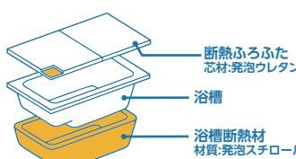
浴槽を断熱材で包み込んだ魔法びんのような構造でお湯
