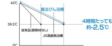
＜試験条件>JIS基準:ユニットバス周囲温度10°C、浴槽湯
